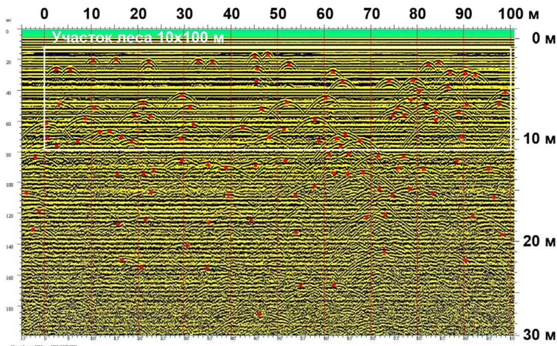
Рис. 3. Радарограмма лесного массива. Расположение стволов деревьев обозначено точками. Белым прямоугольником выделен тестовый участок 10 × 100 м
