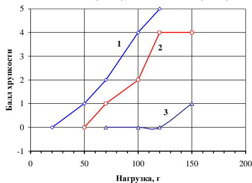
Рис.7. Хрупкость боридных слоев на стали 45: 1- твердофазное борирование; 2- округлые кристаллы (ЭЛБ); 3- эвтектика (ЭЛБ)
