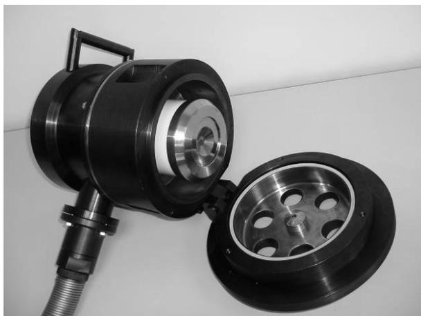
Рис. 9. Внешний вид пушки без фокусирующей линзы.
