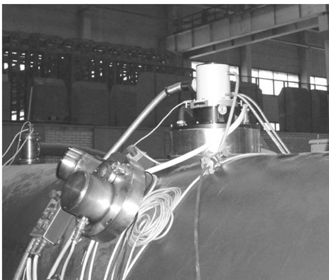
Рис. 6. Электронная пушка с плазменным катодом на установке для сварки циркониевых брикетов.
