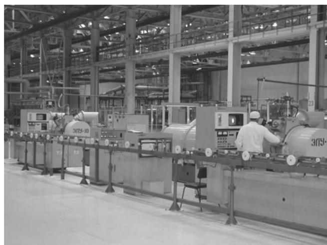
Рис. 5. Автоматическая линия электронно-лучевой сварки ТВЭЛов атомных станций, оснащенная пушками с плазменным катодом.
