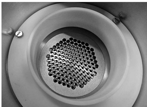
Рис. 2. Мультиапертурная диодная ЭОС – вид со стороны трубы дрейфа (на снимке убрана)
