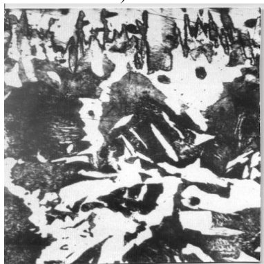
Рис.6. Микроструктуры слоев, сформированных на стали У8А: а) - обмазка на основе B_4C ; б) - обмазка на основе аморфного бора; а)- \times 630 ; б)- \times 500
