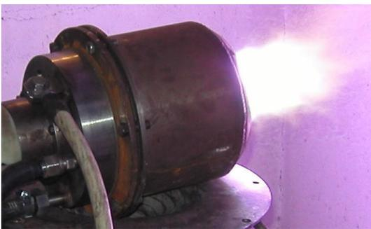
Рис. 1. Электродуговой плазмотрон постоянного тока мощностью до 350 кВт.
