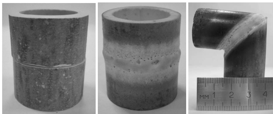
Рис. 10. Керамические трубки на основе талькошамотной массы до и после электронно-лучевой обработки. Ускоряющее напряжение 4 кВ, ток пучка 0.2 А, давление 8 Па
