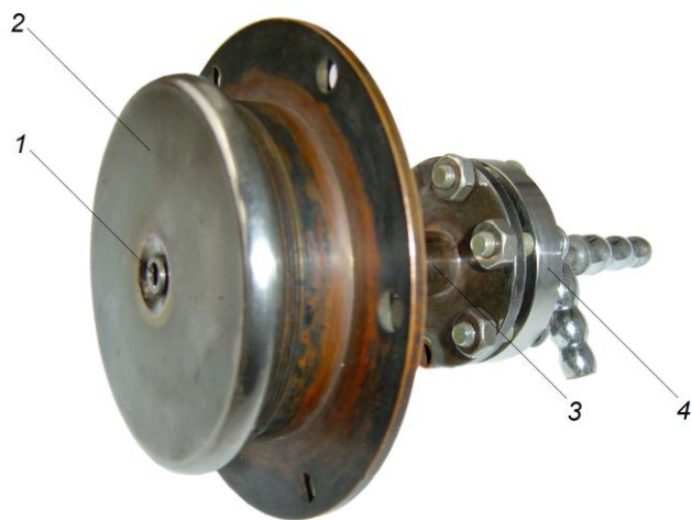
Рис. 3. Общий вид источника ионов: 1- катодная вставка, 2-отражательный катод, 3- полый катод, 4-охлаждаемый держатель мишени
