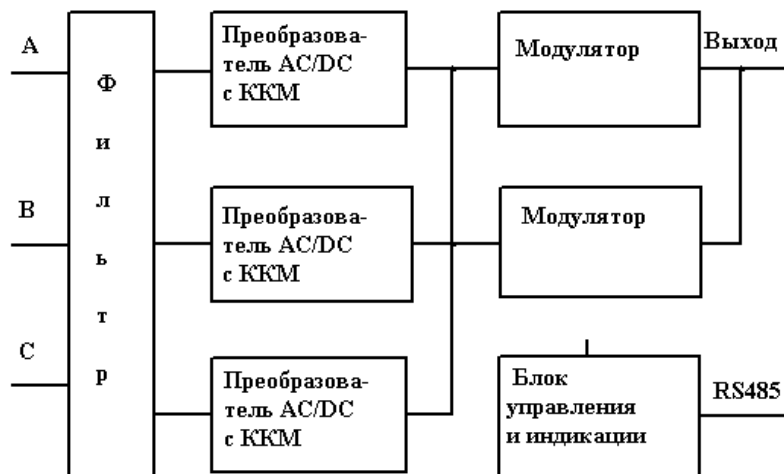
Рис.4. Структурная схема импульсного источника питания магнетрона и осциллограммы напряжения на мишени из молибдена (Y–200 В/дел, X–10 мс/дел.): а) I = 3,2 А, б) I = 3,0 А.
