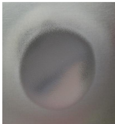
Рис. 7. Распределение плотности энергии по сечению электронного пучка на коллекторе, и оплавленный отпечаток пучка на Ti пластине. I_d = 100 А, U_{\text{уск.}} = 15 кВ, \tau = 100 мкс, p = 3 \cdot 10^{-2} Па, B_z = 30 мТл
