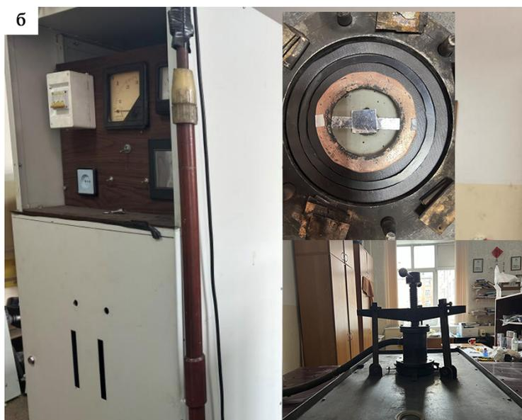
Рисунок 2.1 – Лабораторная установка для нанесения электронно-плазменных покрытий «ЭВУ 60/10»: а – электрическая схема электровзрывной установки ЭВУ 60/10 [117, 118]; б – фотография лабораторной установки
