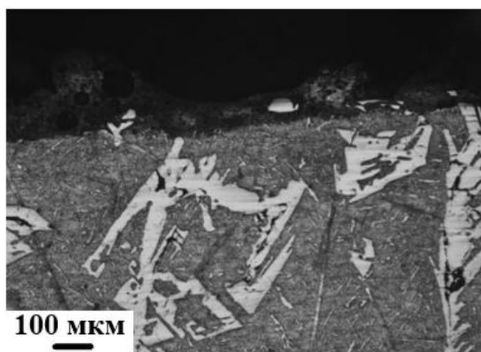
Рисунок 4.10 – Оптическая микроскопия профиля поверхности образцов силумина Al-20%Si
