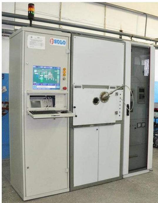
Рисунок 2.2 – Электронно-пучковая установка «СОЛО» [119]
