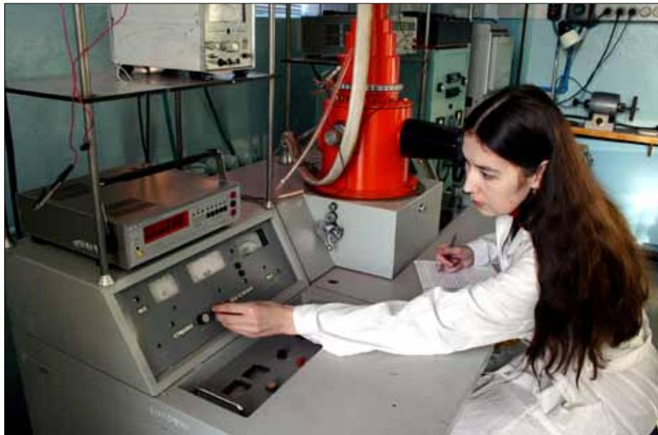
**Выращивание наноразмерных, наноструктурированных слоев углерода со свойствами алмаза распылением ионным пучком**
