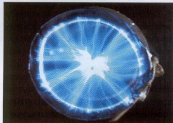
Свечение слаботочного поверхностного разряда с диэлектрическим барьером и свечение многоструйного тлеющего разряда атмосферного давления.
