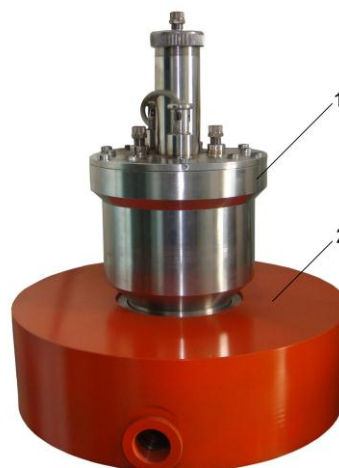
Рис. 5. Общий вид устройства. 1 – плазменный источник ионов, 2 – планарный магнетрон.
